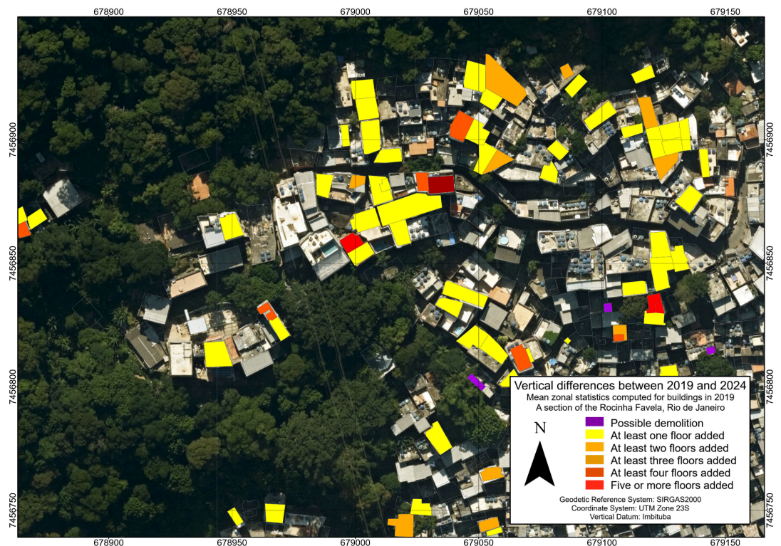
Figura 19: Conjunto de dados vetorial representando a subtração dos modelos de elevação de edificações (2024 menos 2019), após a aplicação de estatísticas zonais às edificações de 2019
