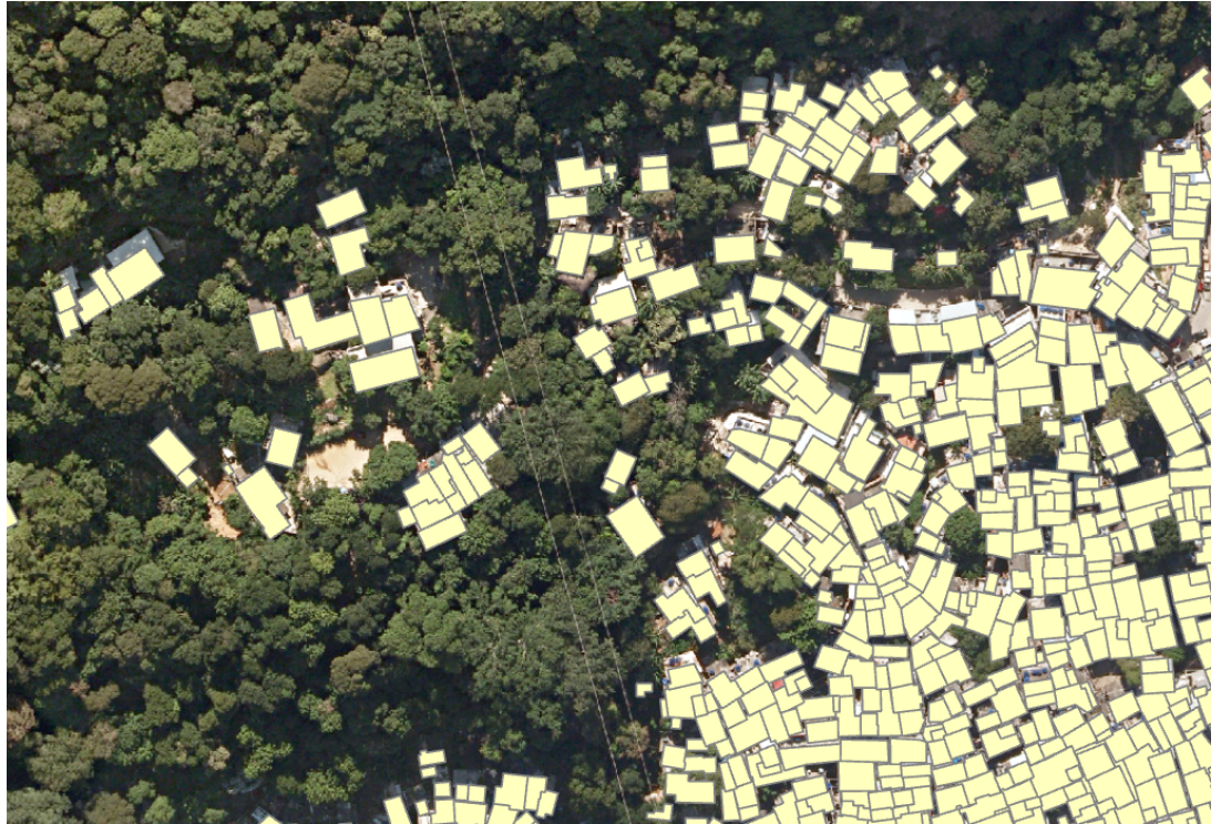
Figura 2: Polígonos de edificações derivados da restituição fotogramétrica de 2013
