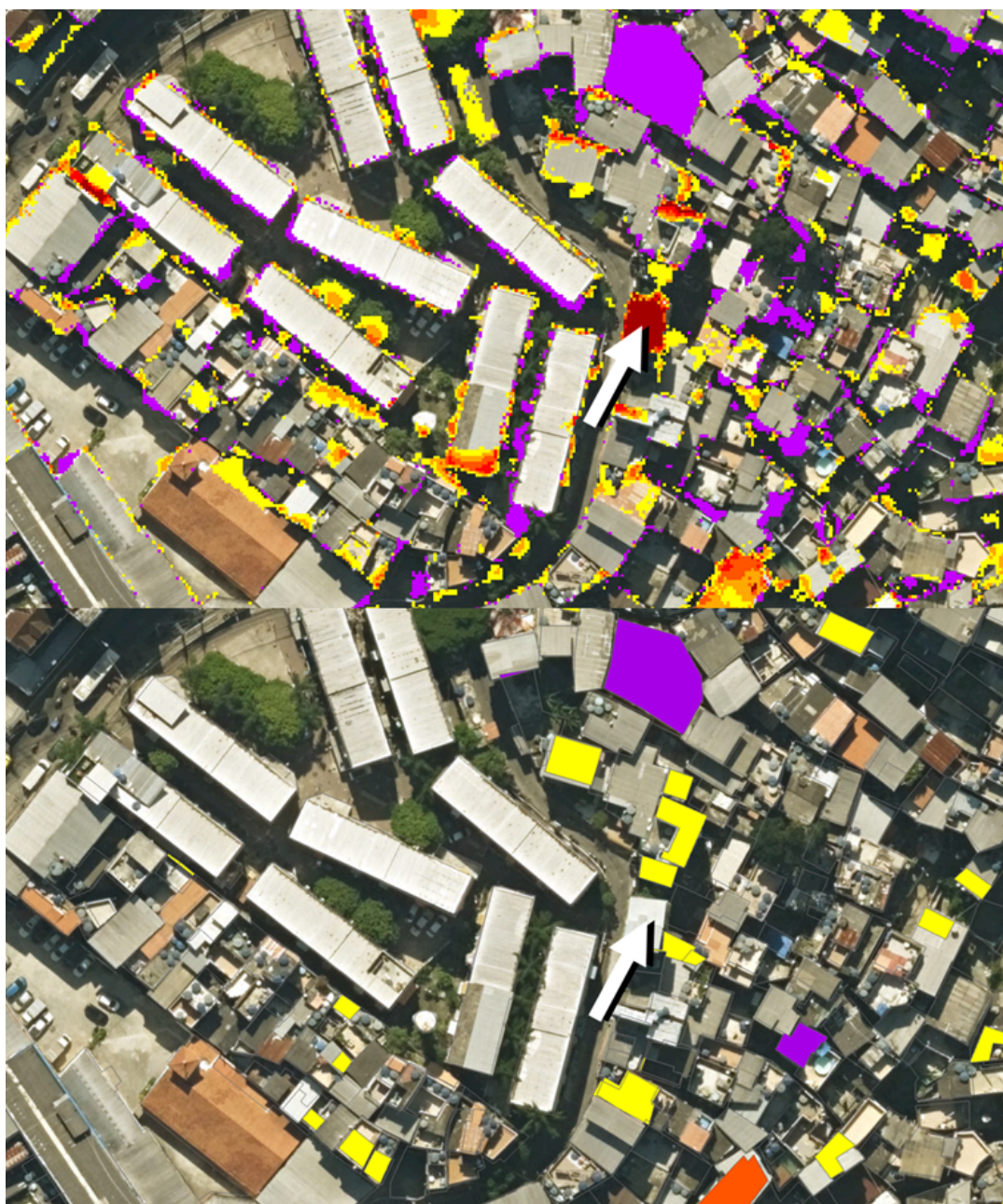
Figura 21: Comparação dos resultados de detecção de mudanças utilizando modelos de dados raster (acima) e vetoriais (abaixo) para o período 2024–2019. O produto raster apresenta ruído nas bordas devido a pequenos deslocamentos planimétricos entre levantamentos, enquanto o produto vetorial, derivado de estatísticas zonais, omite uma nova edificação (ver seta) construída após 2019.
