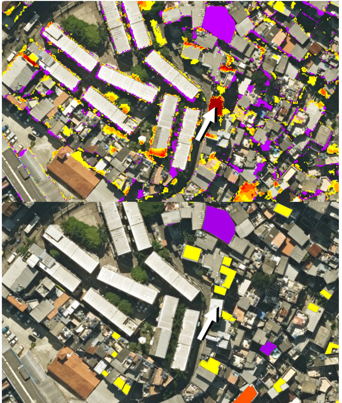
Figura 21: Comparación de los resultados de detección de cambios utilizando modelos de datos raster (arriba) y vectoriales (abajo) para el período 2014–2019. El resultado raster muestra ruido en los bordes debido a pequeños desplazamientos planimétricos entre levantamientos, mientras que el resultado vectorial, derivado de estadísticas zonales, omite una nueva edificación construida después de 2019 (véase la flecha).
