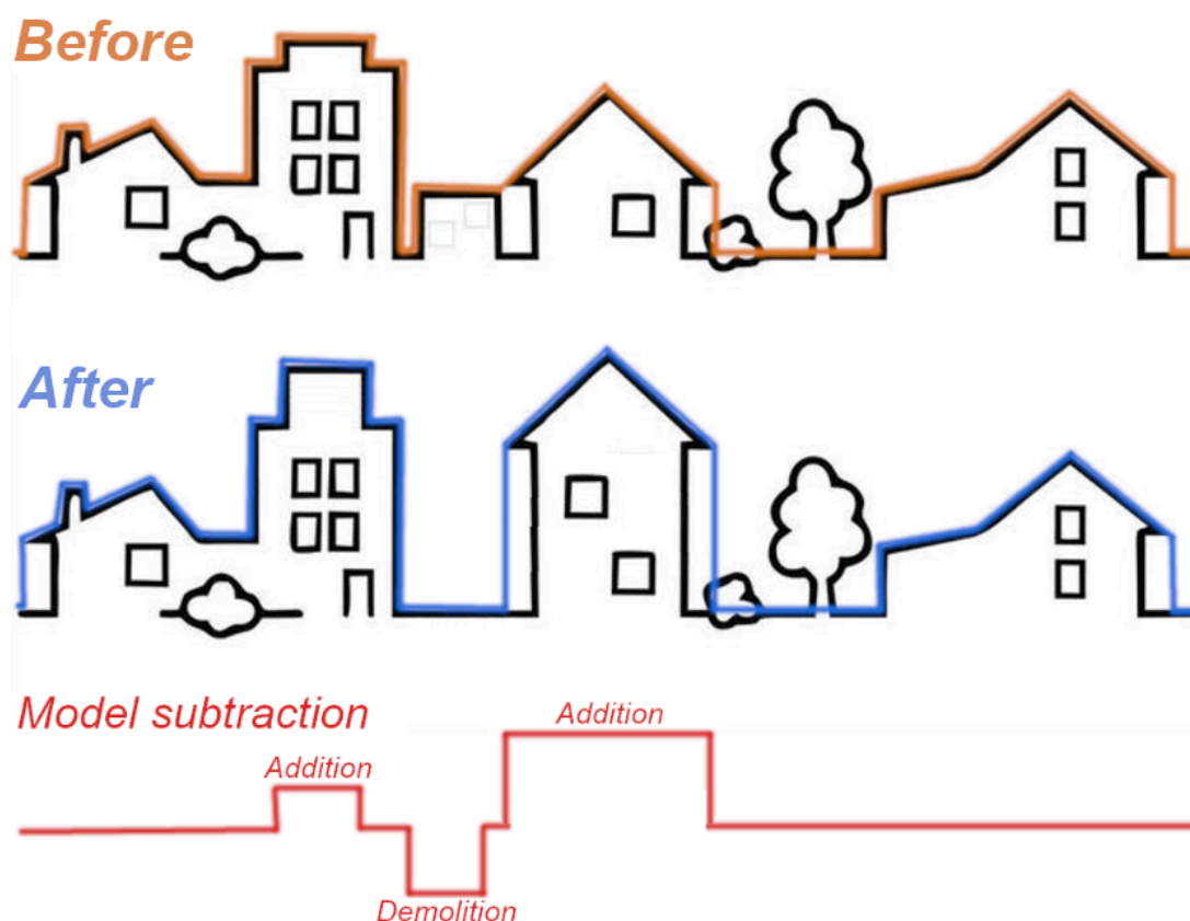
Figura 14: Diagrama esquemático de los posibles resultados derivados de la sustracción de los modelos
