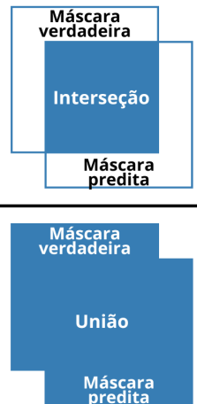
Figura 12: Ilustración del concepto de IoU (Intersection over Union), mostrando el área de intersección entre la máscara verdadera y la máscara predicha en relación al área de unión entre ambas.
